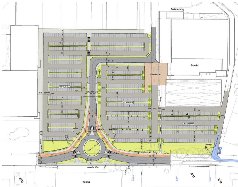
Abbildung 2: Lage und Erschließung des Bauvorhabens, Variante Kreisverkehr (ARGUS, Konzept Kreisverkehr, Stellplatzanlage Variante 2B, Stand: 10.09.2013)
