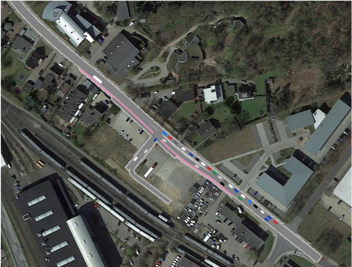
Abbildung 14: Rückstau auf dem Kisdorfer Weg aufgrund von Linksabbiegern zum Ärztehaus
